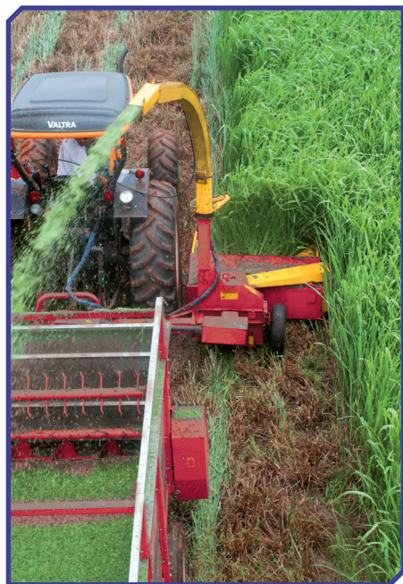
CCPD 1.3 - Plataforma recolhadora de capim e gramíneas plantados em área total, com 3 discos de corte. Plataforma cosechadora de pasto y gramíneas en área total, con 3 (tres) discos de corte.
